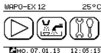
Das Befüllen des Behälters auf Arbeitsniveau und aufheizen des Wassers auf Betriebstemperatur (Dauer ca. 1 1/2 Std.) erfolgen automatisch. Werkseitig liegt diese bei **85°C / 185°F**. Nach dem Erreichen der Betriebstemperatur (Ist-Temperaturanzeige 85°C) sollte Wachslöser eingespült werden. Hierzu benutzen Sie bitte die Handbrause.
