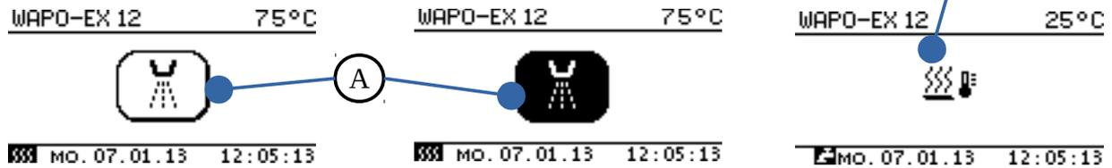
Durch berühren des Symbols **(A)** wird der Handbrausenvorgang gestartet. Das Symbol invertiert sich. Durch berühren des invertierten Symbol **(A)** wird der Prozess gestoppt.
